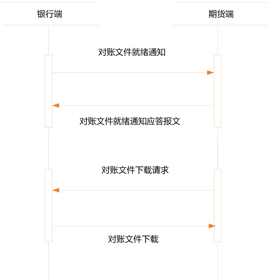
图 61 银行端发起日终对账业务的逻辑分析流程
